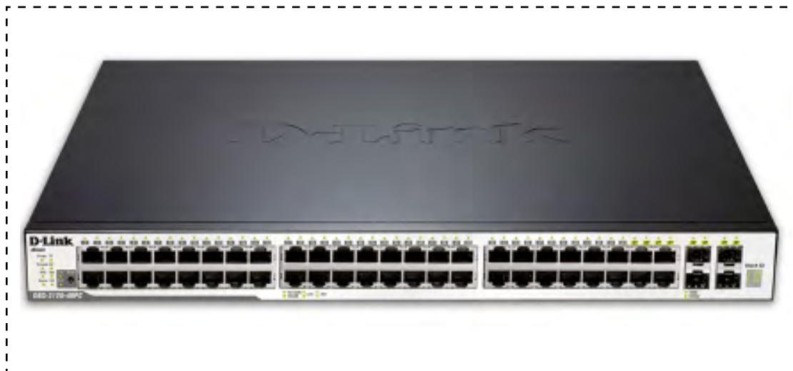
Figura 0.3. Switch de 48 puertos
