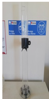
Figura 89. Columnas de lixiviación
