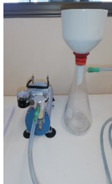
Figura 73. Sist. filtrado: bomba vacío-matriz kitasato-embudo Buchner
