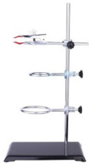
Figura 41. Soporte universal con argollas, pinzas metálicas
