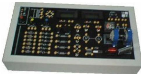
Figura 5: Entrenador básico de electricidad y electrotecnia, con simulador de averías
