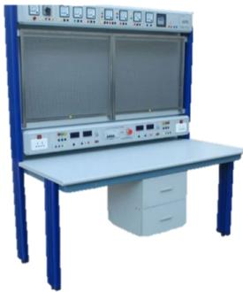
Figura 1: Bancos de trabajo eléctricos con rejillas para la realización de prácticas de montajes de circuitos eléctricos
