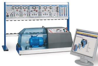
Figura 8: Entrenador modular máquinas eléctricas
